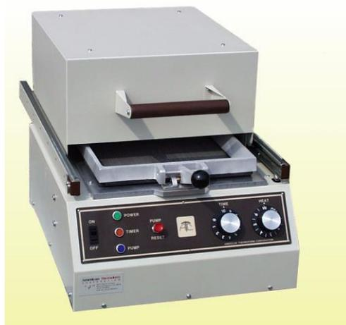
Die Vakuum-Verformungsmaschine "Thermoform Brailon Duplicator" ist ein einfaches, sicheres und schnelles Gerät zur Herstellung von Unterrichts- und Ausbildungsmaterialien für Blinde. Auf dem Wege der Vakuum-Verformung fertigt das Gerät kostengünstig dauerhafte Kopien von Brailleschrift und anderen taktilen Vorlagen aus stabiler Kunststoffolie.
